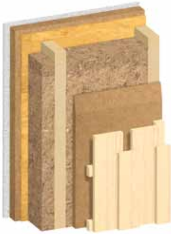
Fachada ventilada en entramado ligero
