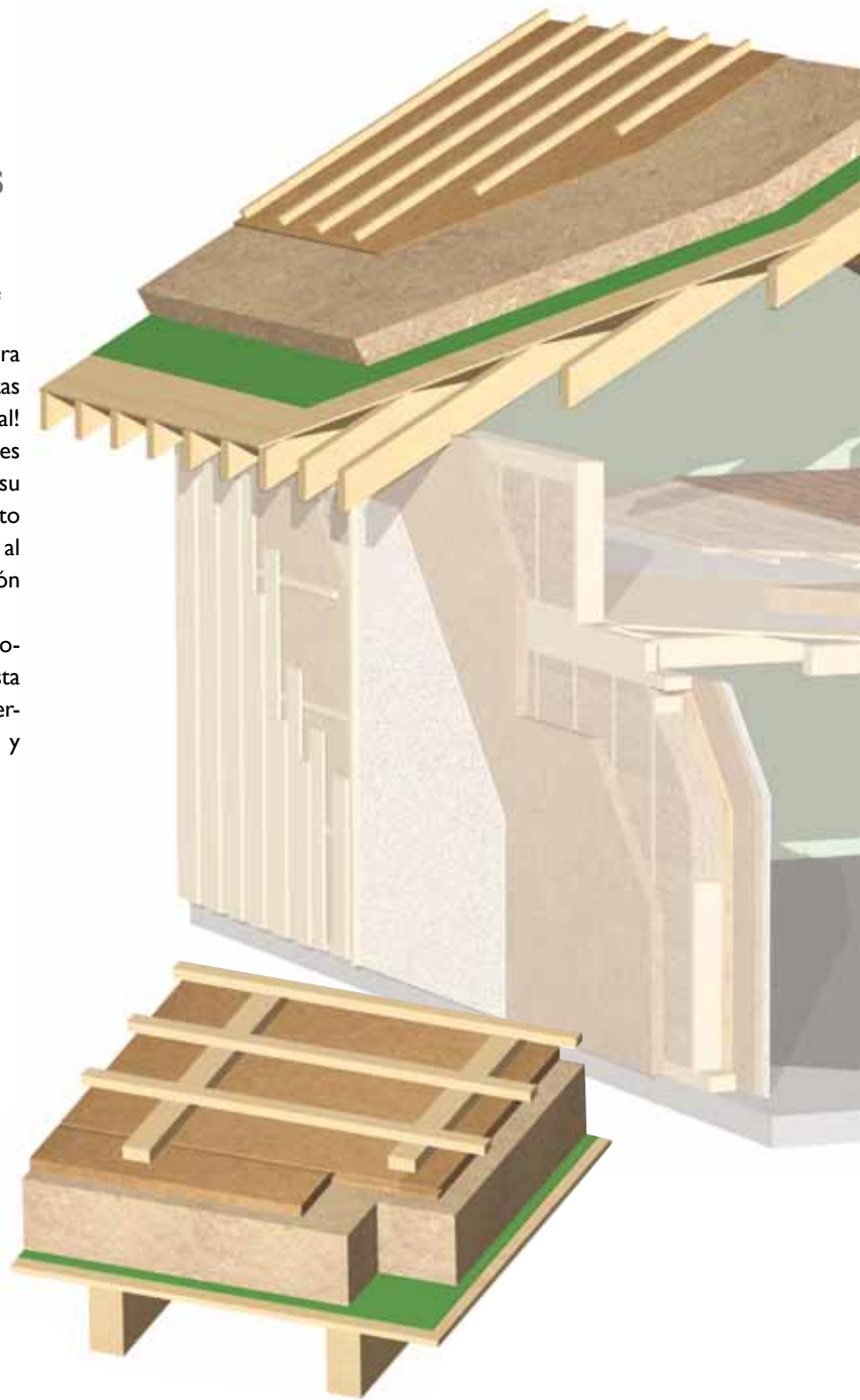
Solución constructiva de aislamiento sobre cabios con GUTEX Thermosafe-homogen y GUTEX Multiplex-top
