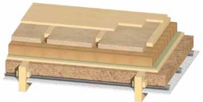
GUTEX Thermosafe-nf con rastrel de colocación incorporado
