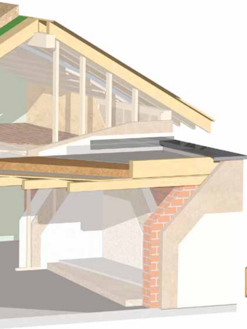
GUTEX Thermoflat sobre fondo de madera
